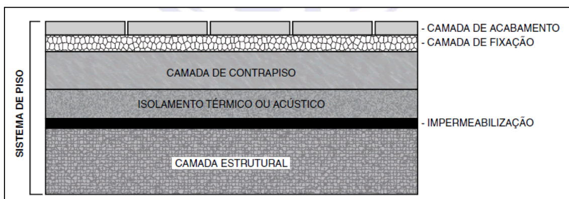
Figura 13 - Exemplo genérico de um sistema de pisos e seus elementos. Fonte: NBR 15575-3:2013.
